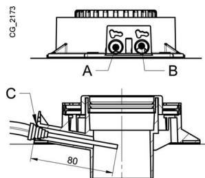
Temperatura aerului de combustie se măsoară la priza de pe circuitul de admisie aer (B) prin introducerea sondei cu circa 8 cm (C).
