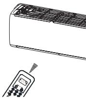
Utiliser la télécommande dans un rayon de 8 mètres de l'appareil en le pointant vers le récepteur.
